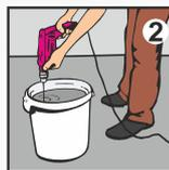
2 Перемешивайте раствор дрелью со специальной насадкой на низких оборотах, засыпая сухую смесь в воду до получения однородной пастообразной массы. Приготовленную смесь используйте сразу после перемешивания (в течение 6-7 минут).
